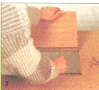
Дно вольера кладут в фальцы поперечных брусьев и привинчивают его шурупами.
